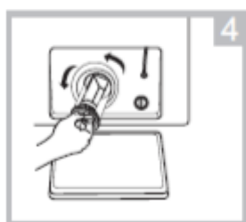
Desfaceți filtru prin rotire în sens contrar acelor de
